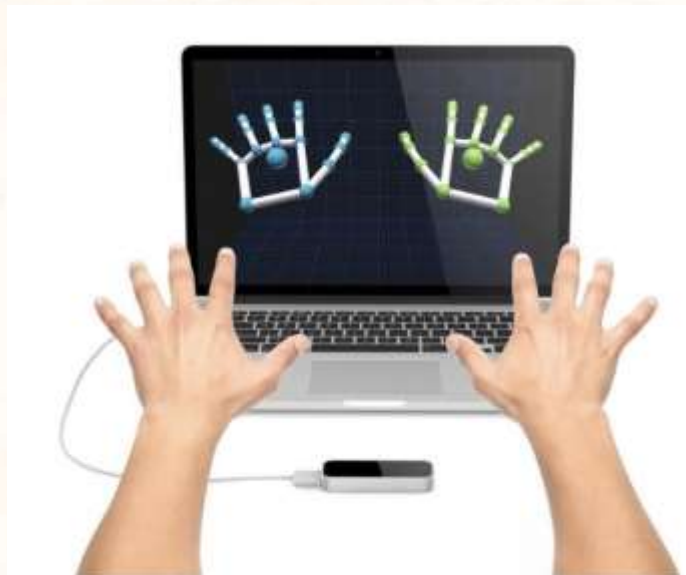
Figura 2 – Sensor Leap Motion utilizado para captura dos movimentos das mãos dos participantes.
