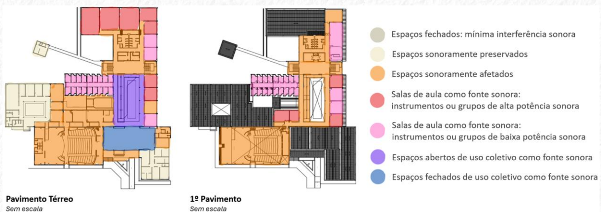
Figura 4 – Tipologia exclusiva: relações acústico-espaciais analisadas nas plantas baixas da EMUFRN
