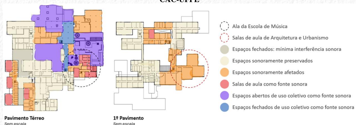
Figura 3 – Tipologia compartilhada: relações acústico-espaciais analisadas nas plantas baixas do CAC-UFPE
