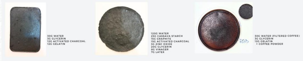
Figura 6: Estudo de receitas base com dopagem de ingredientes que pudessem incrementar a condutibilidade do material
