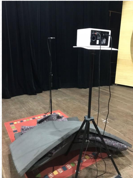
Figura 2 – Aparato de medição das curvas de respostas de frequência por meio da resposta impulsiva
