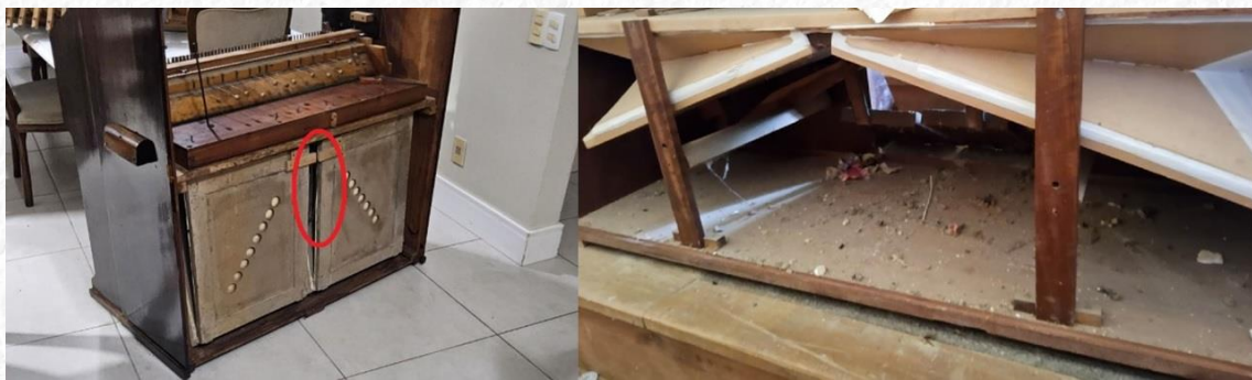
Figura 3 – Sistemas de foles nos harmônios Bohn (esq.) e Schürle (dir.); destaque para a mola no modelo de Bohn
