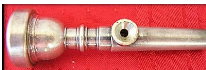
Imagem 1: Bocal com furo adaptado para captador 9 .
