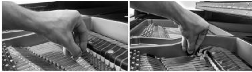
Figura 5: Duas formas diferentes de se segurar a palheta de acordo com a proximidade dos ferros de sustentação.
