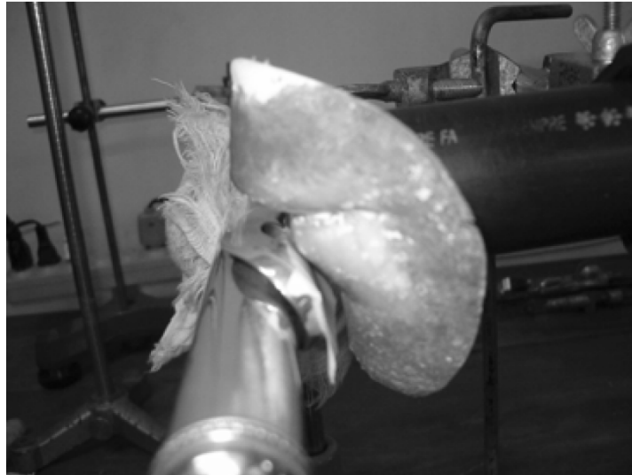
Figura 1: modelo de embocadura em fibra de vidro – visão lateral.
