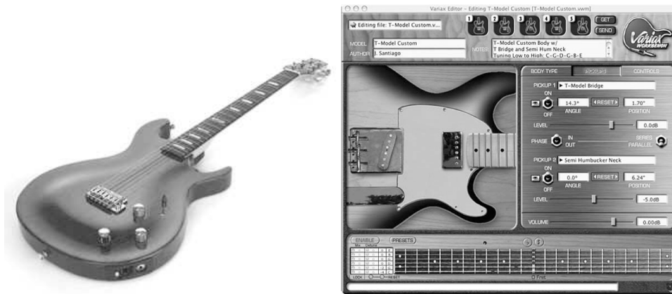
Figura 5 – Guitarra Variax da Line 6 e seu programa de acesso ao processador interno, o workbench .
